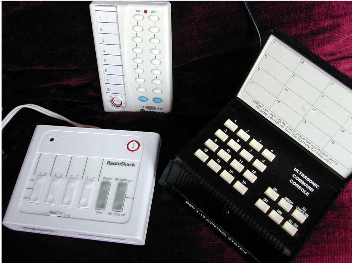
Slika 1. X10 upravljači: jednostavan upravljač, radioupravljač i originalna konzola za naredbe koja se može koristiti s ultrazvučnim daljinskim upravljačem [3]
