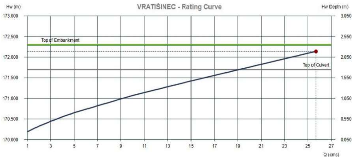
Slika 21. Hidraulički proračun – krivulja
