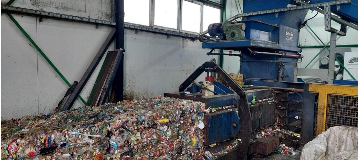
Slika 10. Tehnix automatska preša-balirka 50 t
