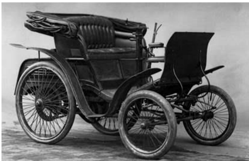
Slika 2.1 Prvi serijski proizveden automobil Benz Velo
