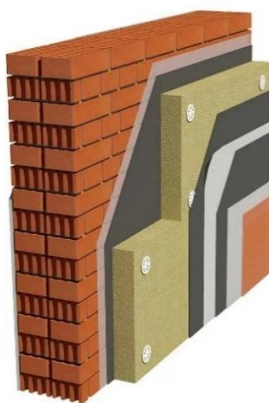
Slika 8. Slojevi toplinske izolacije
