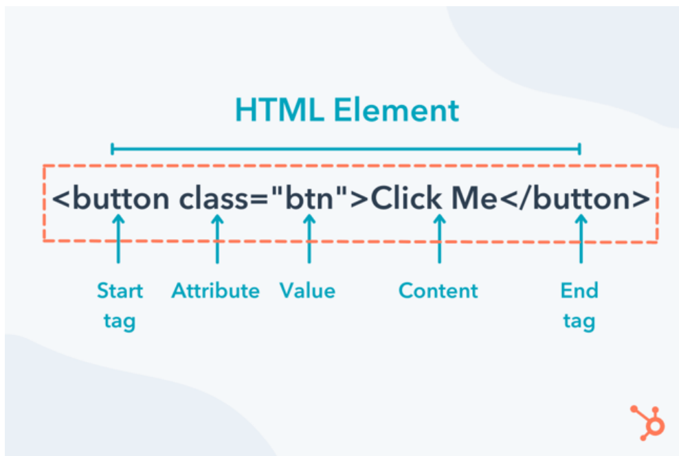
Slika 3. HTML element (gumb) i njegova struktura
