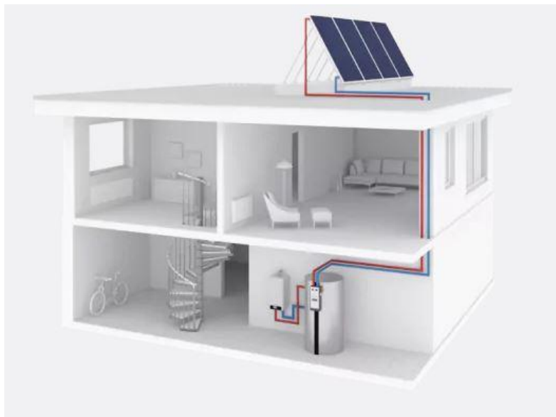
Slika 3. Kondenzacijska tehnika - solarni sustav (Izvor: https://gradimozadar.hr )
