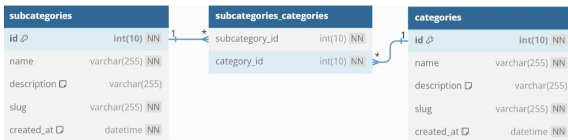
Slika 38. Tablica „subcategories_categories“ i veze s tablicama „subcategories“ i „categories“
