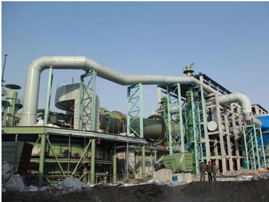
Slika 12. Peć prilagođena za spaljivanje medicinskog otpada
