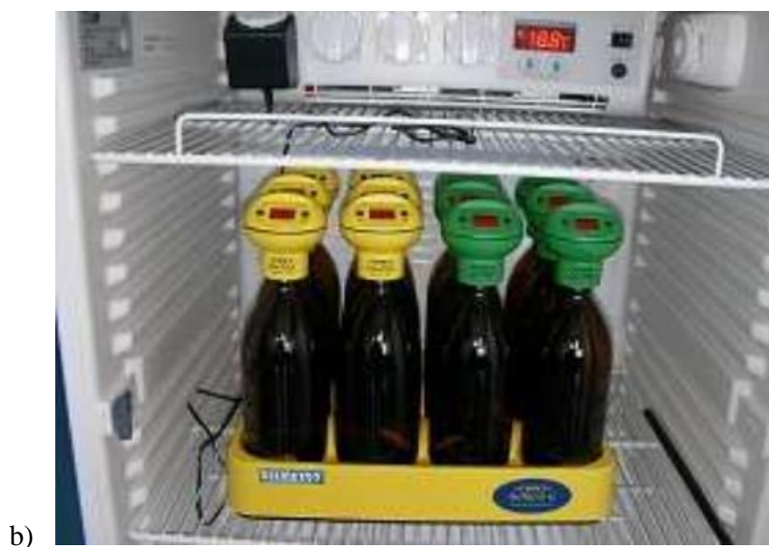
Slika 13. a) Natrijev hidroksid u ljuskicama i b) Oxitop na staklenim tamnim bocama
