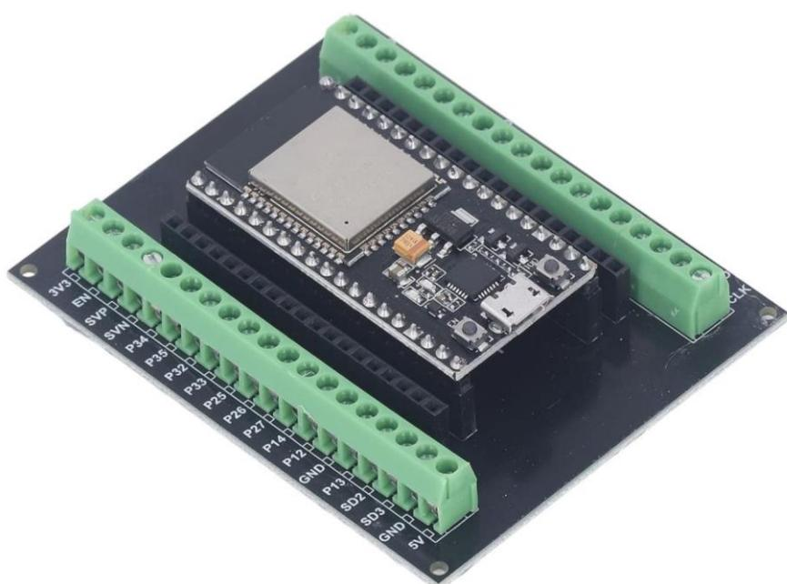
**Slika 4.** Prikaz pločice kada je ubaćena u terminal adapter
