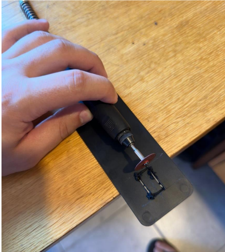
Slika 35. Rezanje otvora za OLED zaslon
