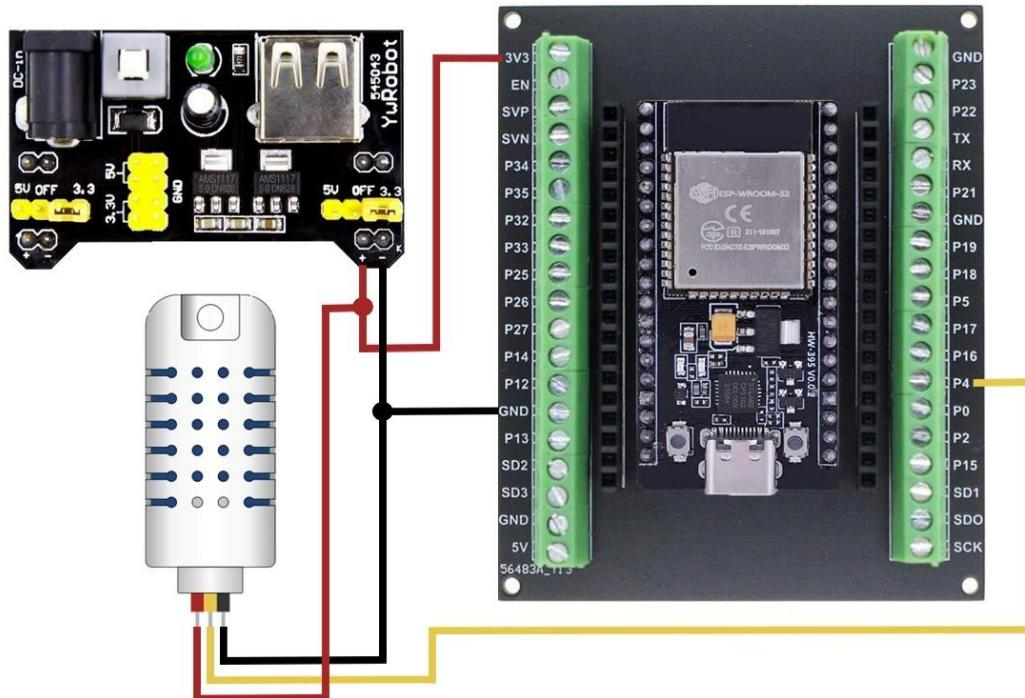
**Slika 20.** Prikaz spajanja DHT senzora
