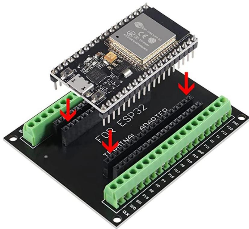
**Slika 3.** Ubacivanje ESP32 mikrokontrolera u terminal adapter
