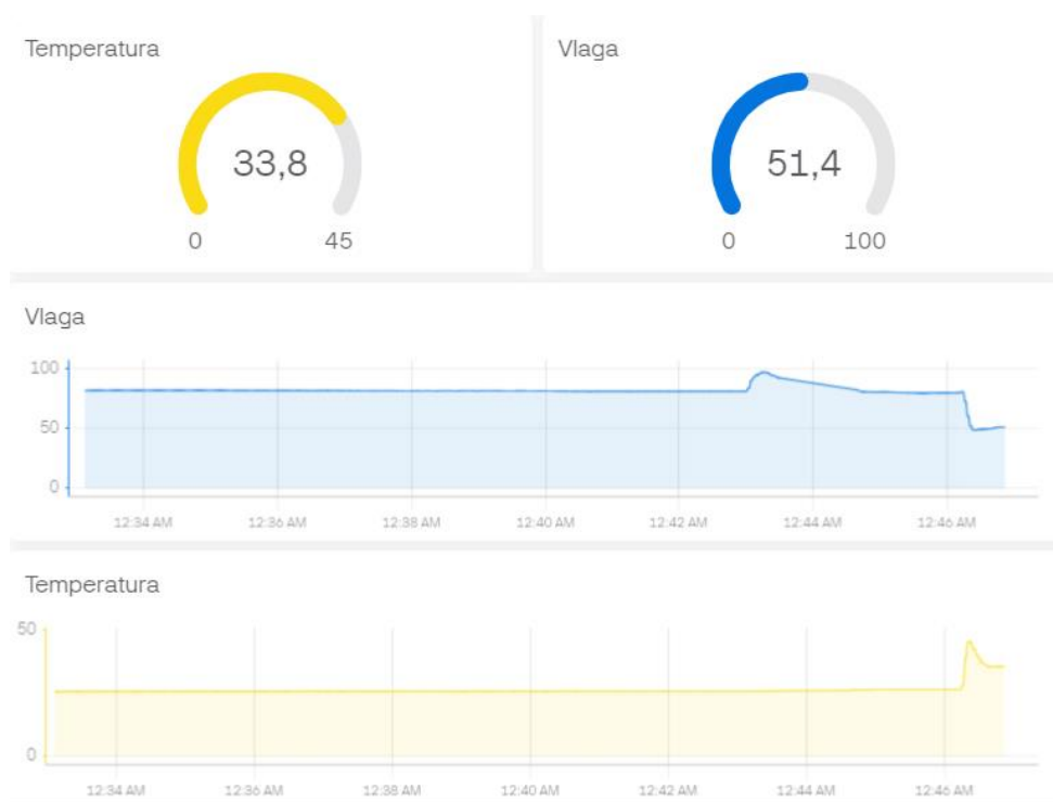
Slika 29. Prikaz trenutnih vrijednosti temperature i vlage na Blynk web sučelju
