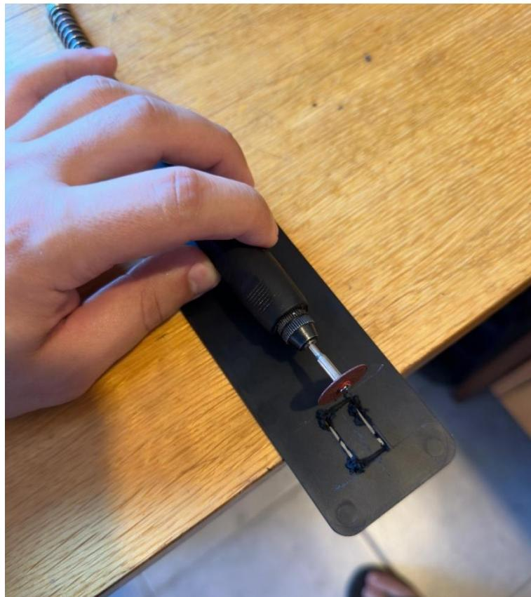
**Slika 35.** Rezanje otvora za OLED zaslon
