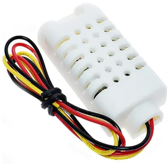
**Slika 6.** AM2302 senzor za temperaturu i vlažnost zraka
