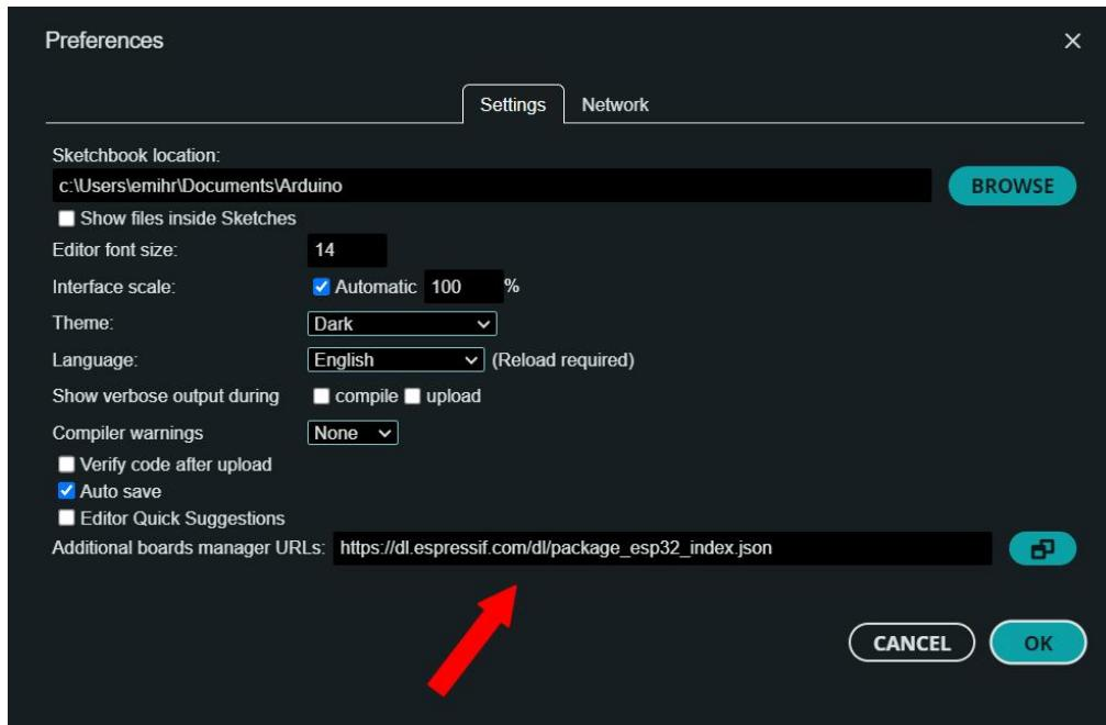
**Slika 14.** Dodavanje ESP32 mikrokontrolera u Arduino IDE
