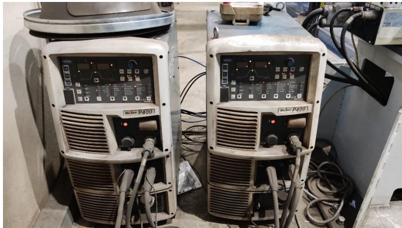
Slika 28 Izvori struje OTC P400
