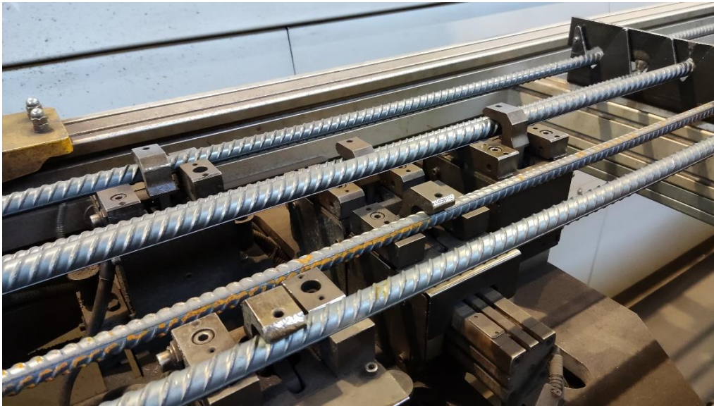
Slika 37 Hvataljke u zatvorenom položaju
