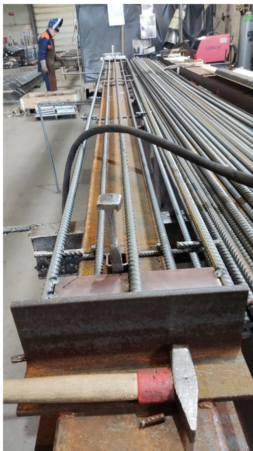
Slike 24 Šablona sa zateznim elementom
