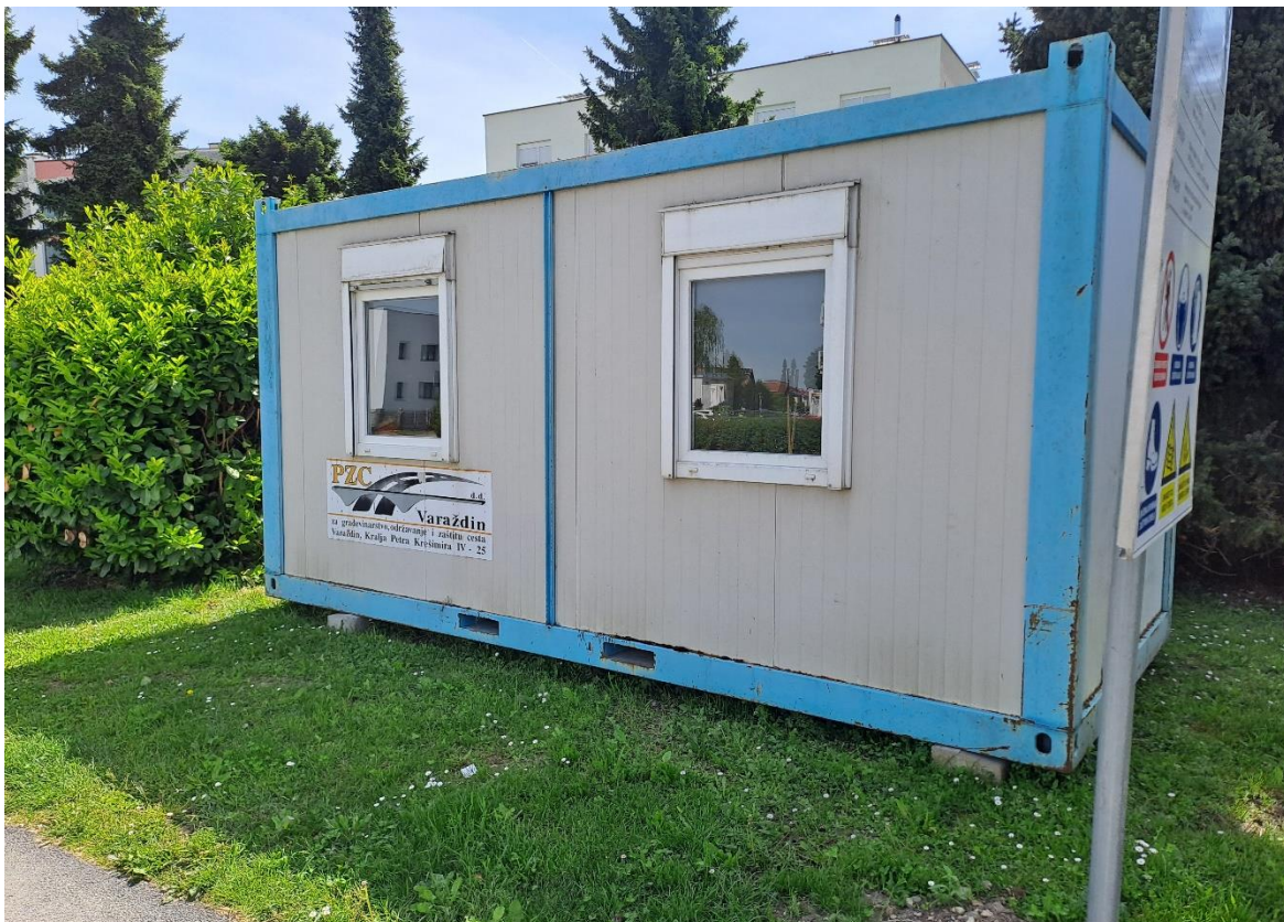
Slika 17. Kontejnerski smještaj ljudi na gradilištu
