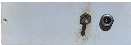
Slika 29. DC priključak i preklopni prekidač
