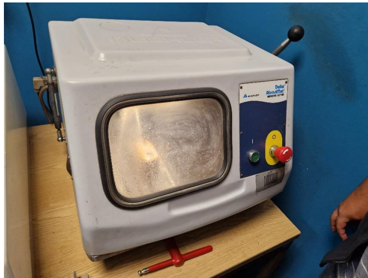
Slika 69. – Abrazivni rezač Beuhler Delta AbrasiMet
