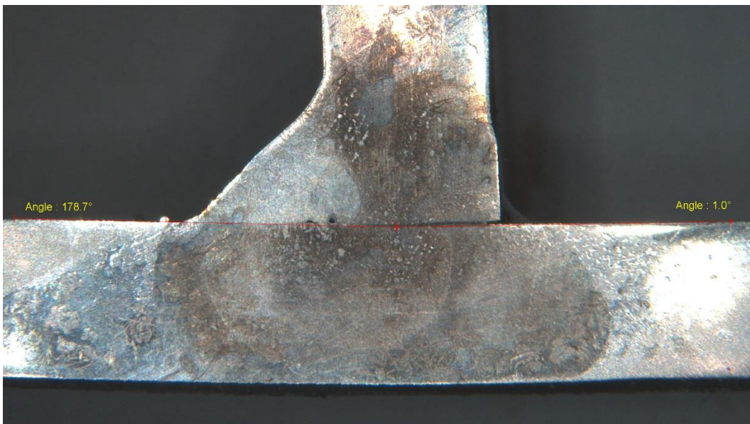
Slika 91. – Kutna deformacija MAG 6mm
