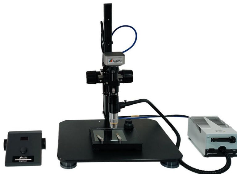
Slika 37. – Digitalni mikroskop za snimanje makroizbrusaka
