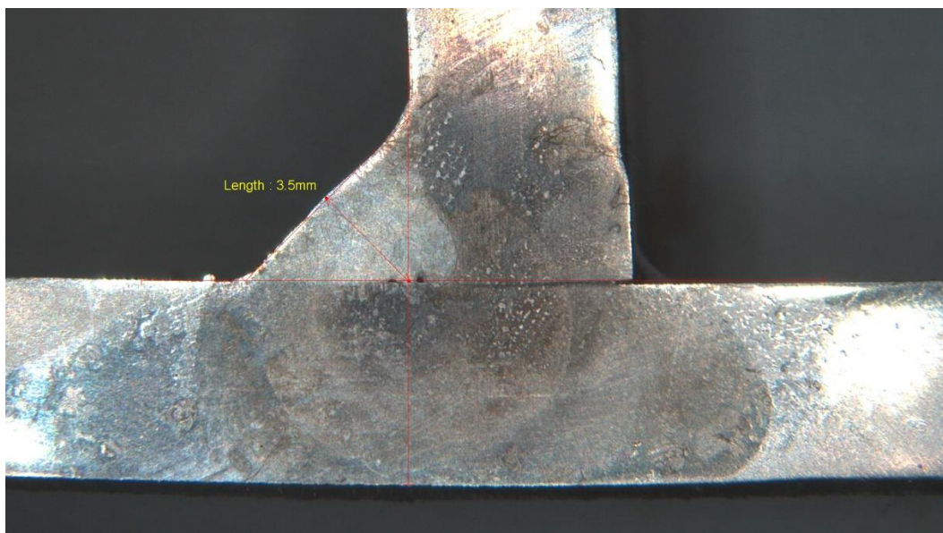
Slika 89. – Dimenzija zavara MAG 6mm
