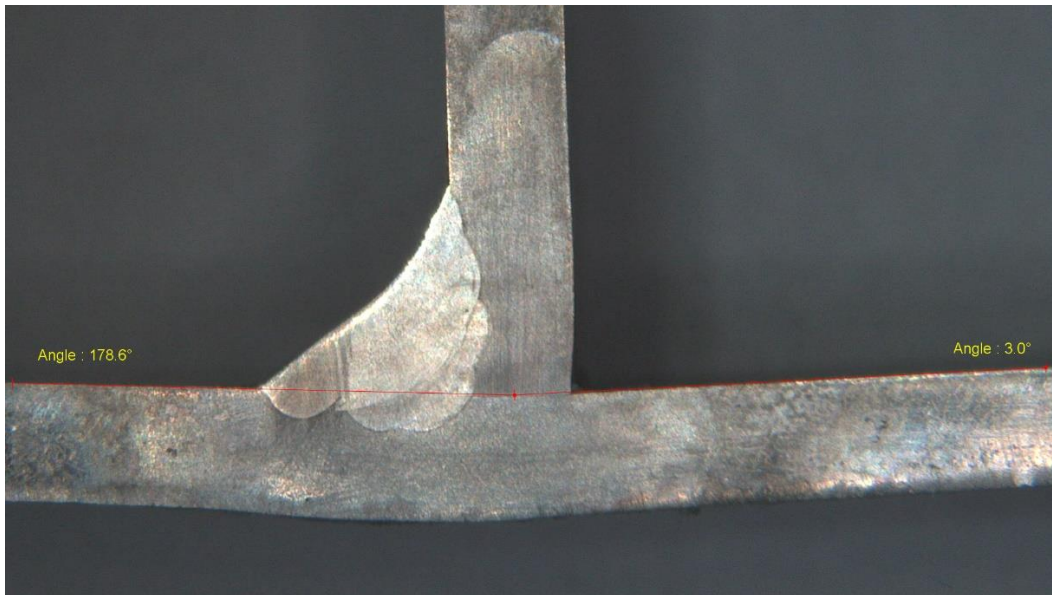
Slika 82. – Kutna deformacija TIG 3mm
