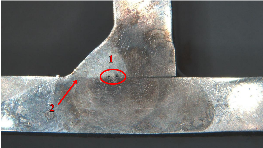
Slika 92. – Plinski mjehurić - pora MAG 6mm
