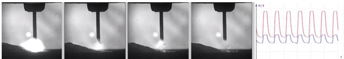
Slika 52. – Prijenos metala pulsirajućim lukom
