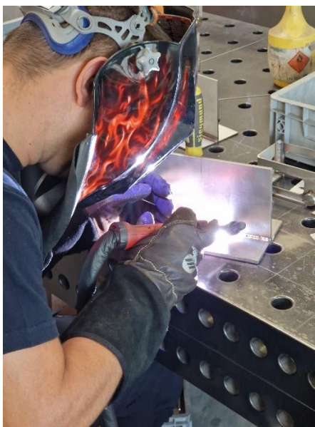
Slika 59. – Zavarivanje TIG postupkom
