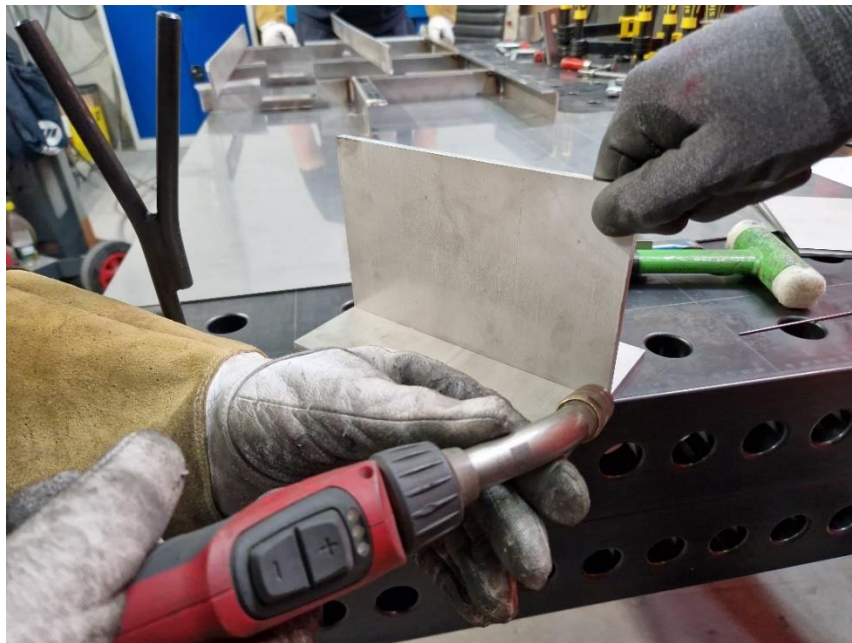
Slika 63. – Točkasto zavarivanje pločica MAG postupkom
