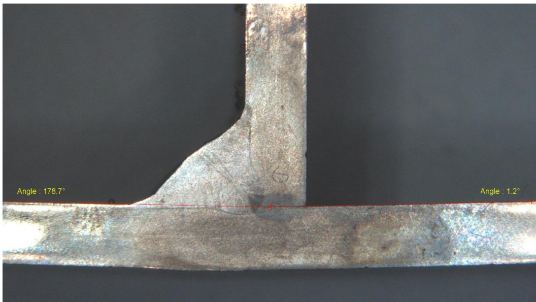
Slika 85. – Kutna deformacija MAG 3mm
