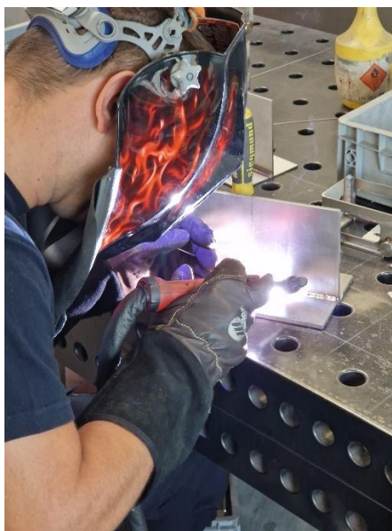
Slika 59. – Zavarivanje TIG postupkom
