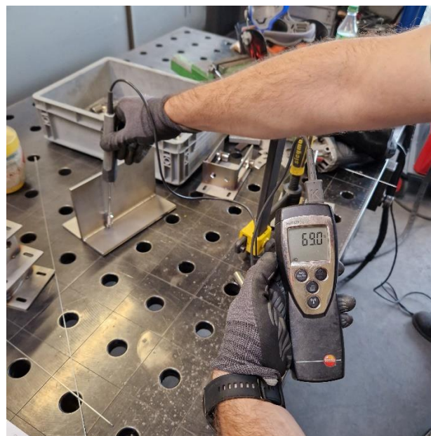
Slika 65. – Mjerenje temperature međuprolaza kontaktnim termometrom
