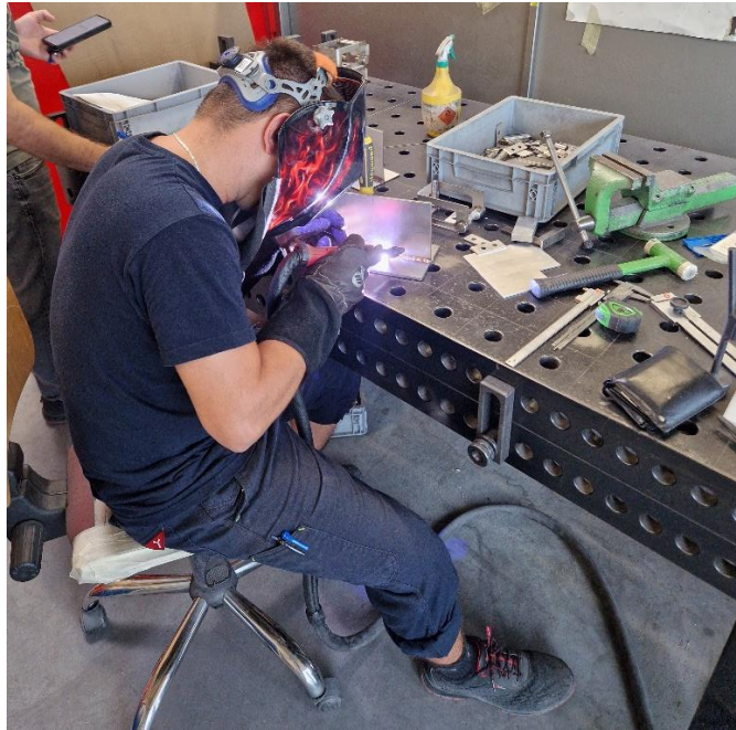
Slika 64. – Zavarivanje pločica TIG postupkom
