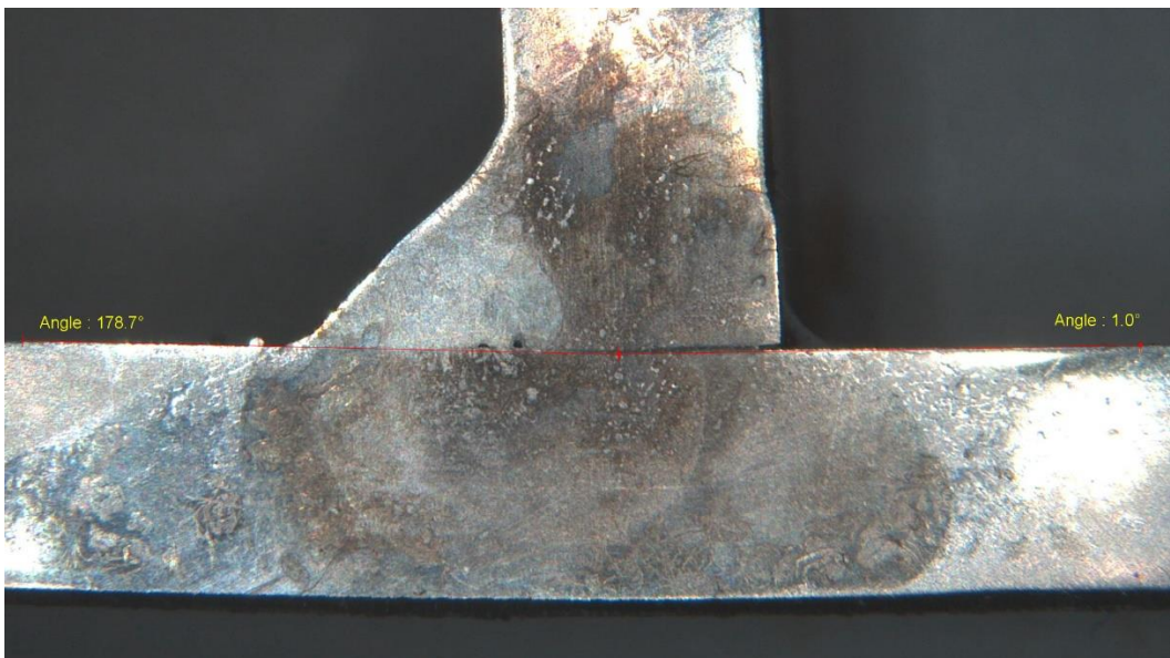
Slika 91. – Kutna deformacija MAG 6mm
