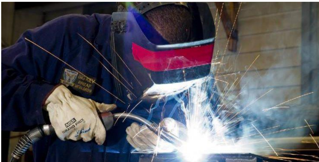
Slika 1. – Zavarivanje MIG/MAG postupkom
