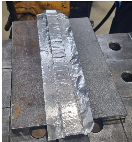
Slika 24. Keramika za zavarivanje
