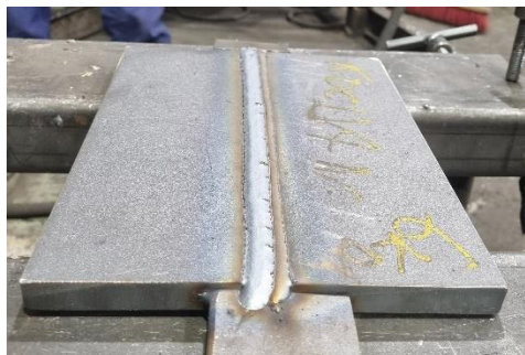
Slika 18. Zavareni sučeljeni zavar konvencionalnim MAG postupkom
