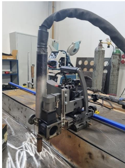
Slika 22. Pištolj i vodilica za D-Arc zavarivanje
