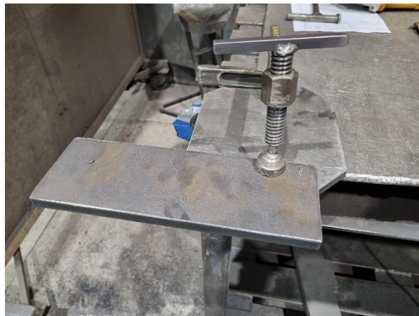
Slika 12. Stezanje radnog komada za radni stol
