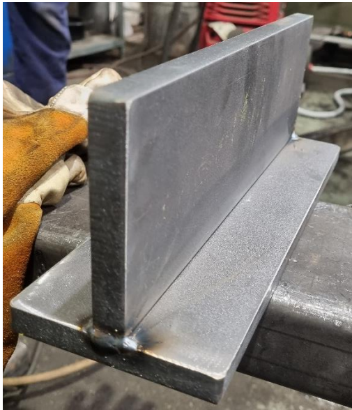
Slika 19. Priprema za kutni zavar konvencionalnim MAG postupkom
