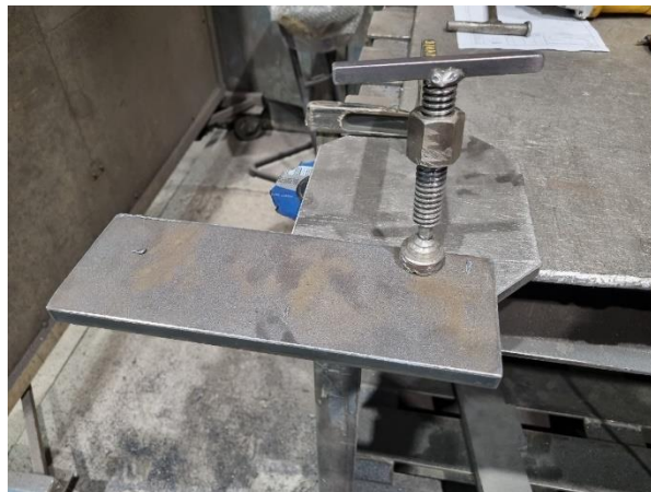
Slika 12. Stezanje radnog komada za radni stol
