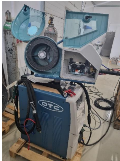
Slika 21. Oprema za D-Arc zavarivanje
