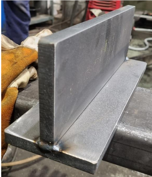
Slika 19. Priprema za kutni zavar konvencionalnim MAG postupkom
