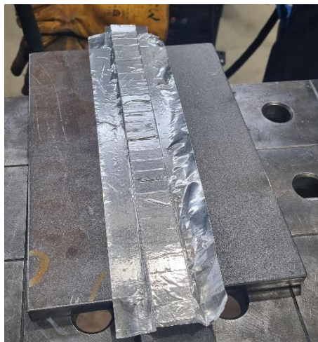
Slika 24. Keramika za zavarivanje
