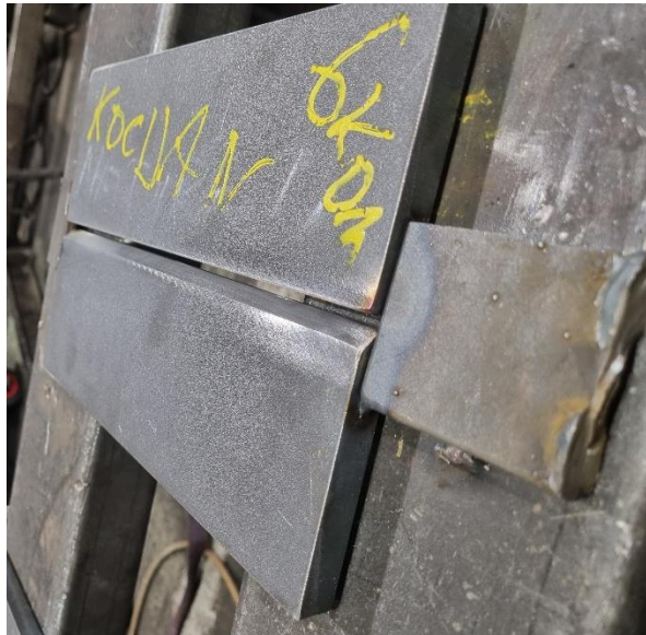
Slika 15. Dva radna komada spremna za spajanje konvencionalnim MAG postupka
