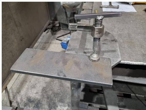
Slika 12. Stezanje radnog komada za radni stol
