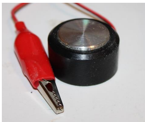
Slika 23. CNC touch senzor
