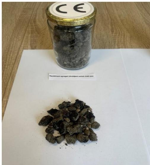
**Slika 10.** Reciklirani agregat (drobljeni asfalt) 0/45 mm [5]
