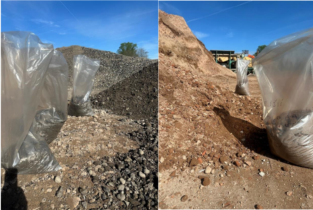
Slika 14. Uzimanje uzoraka za ispitivanje recikliranog agregata [5]
