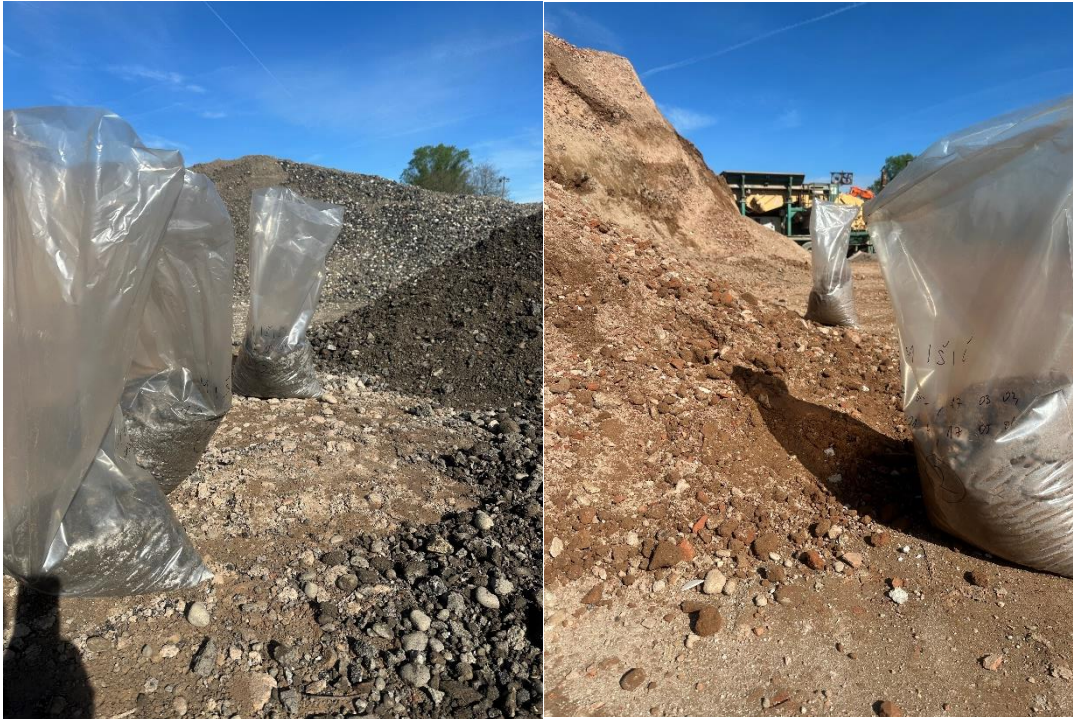
Slika 14. Uzimanje uzoraka za ispitivanje recikliranog agregata [5]
