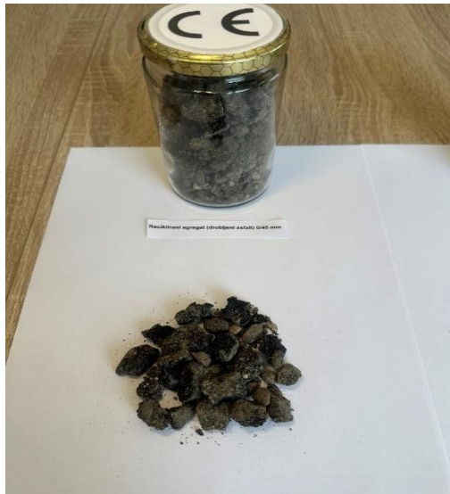
Slika 10. Reciklirani agregat (drobljeni asfalt) 0/45 mm [5]
