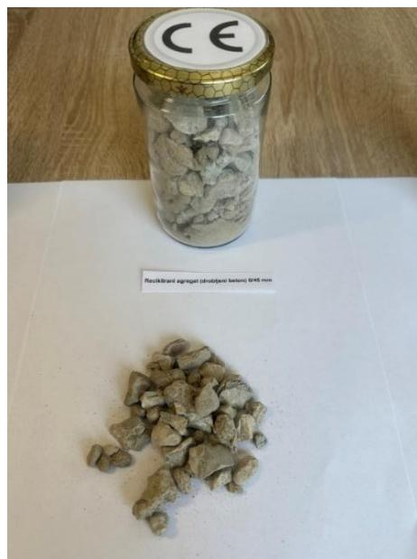
**Slika 11.** Reciklirani agregat (drobljeni beton) 0/45 mm [5]
