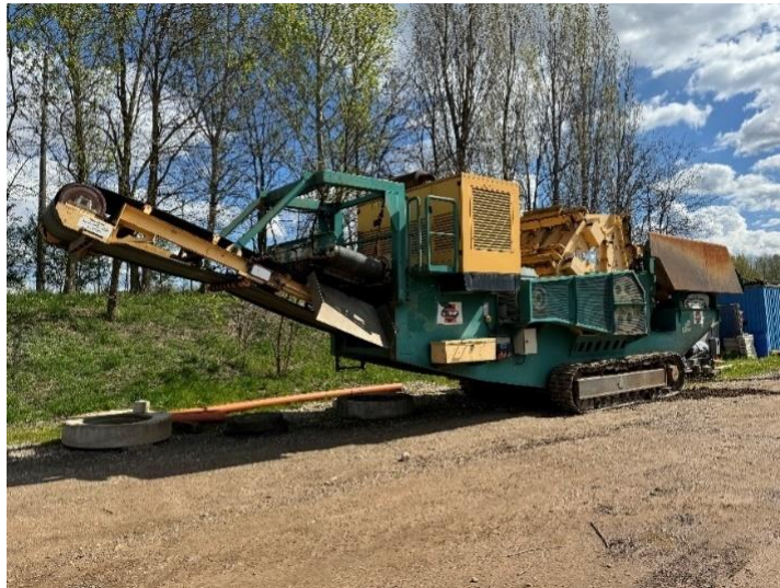
Slika 9. Udarna drobilica MFL RCI 100/130 [5]
