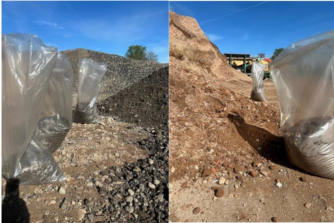
**Slika 14.** Uzimanje uzoraka za ispitivanje recikliranog agregata [5]
