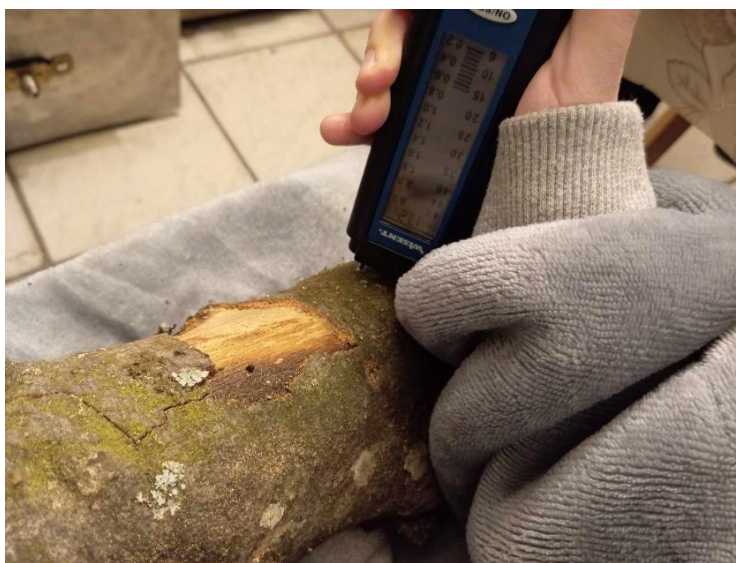
Slika 17: Mjerenje vlažnosti drva
