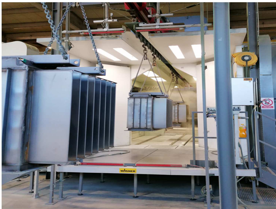
Slika 24. Automatsko praškanje u kabini
