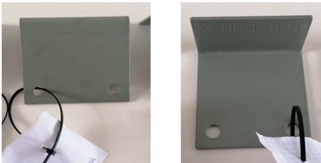
□) Kemijski obrađen testni uzorak
