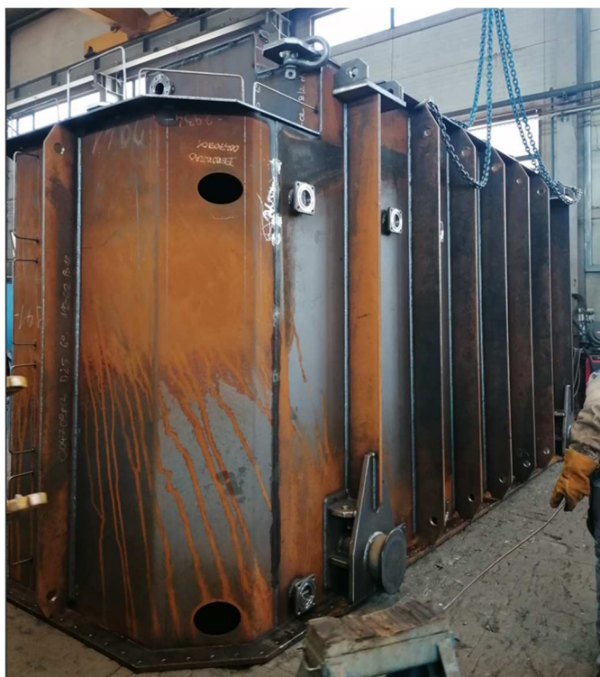
Slika 1. Primjer korozije (hrđanja) željeza
