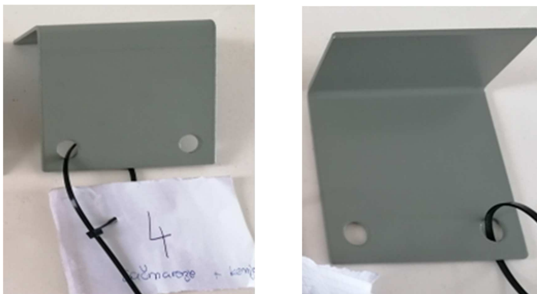
d) Sačmaren + kemijski obrađen testni uzorak
