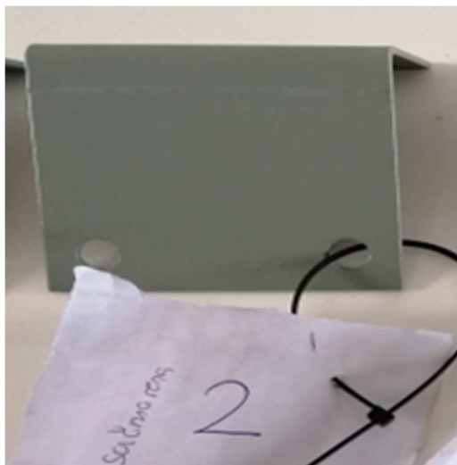
b) Sačmarenji testni uzorak
