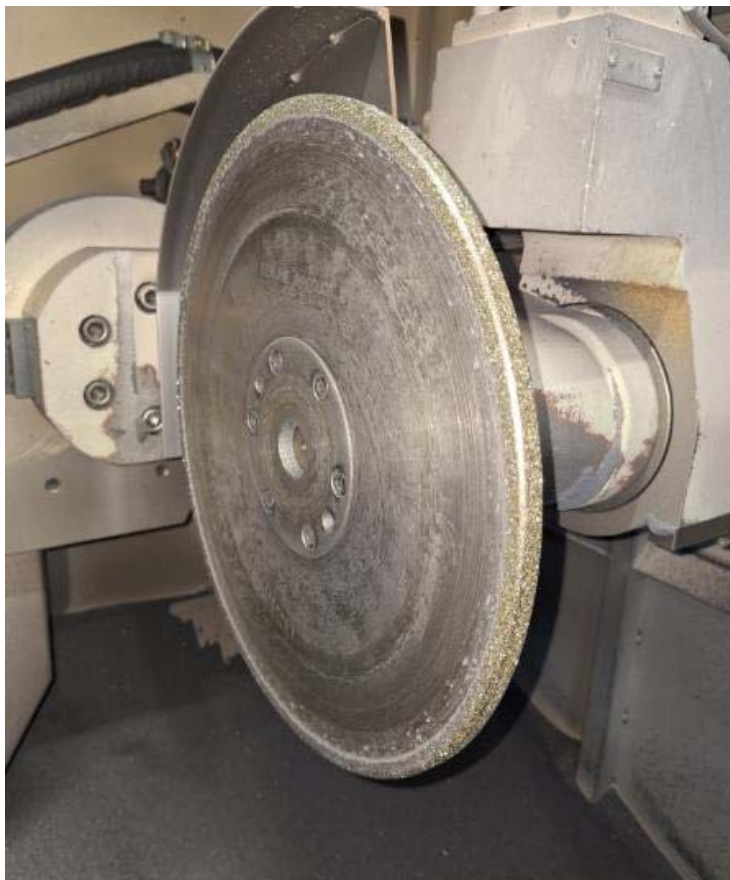
Slika 15. Glavni cirkular alata, Ferro-Preis d.o.o.
