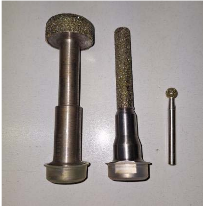
Slika 18. Dijamantna glodala, granulacija S851, Ferro-Preis d.o.o.
