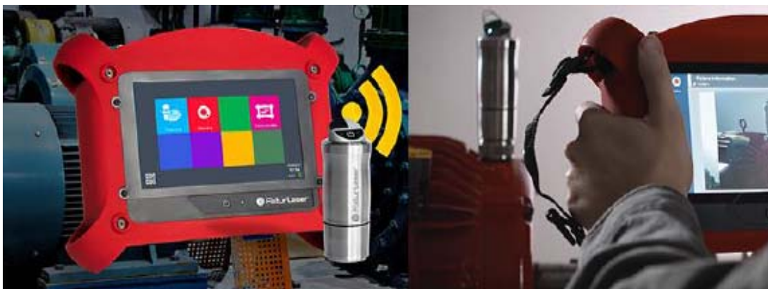
Slika 24. Fixturlaser uređaj za vibrodijagnostiku, Ferro-Preis d.o.o.
