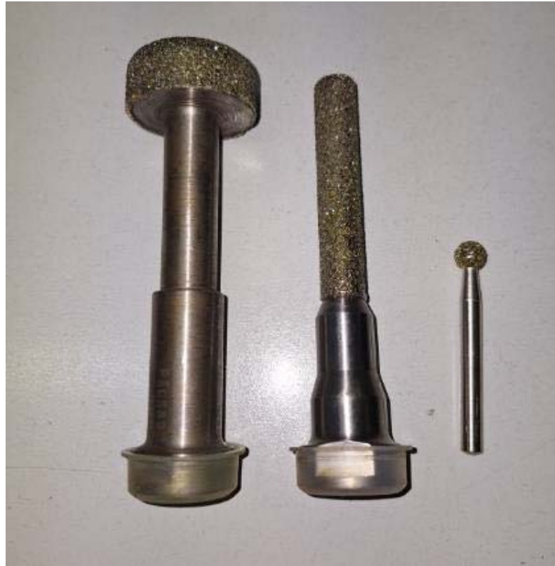
Slika 18. Dijamantna glodala, granulacija S851, Ferro-Preis d.o.o.
