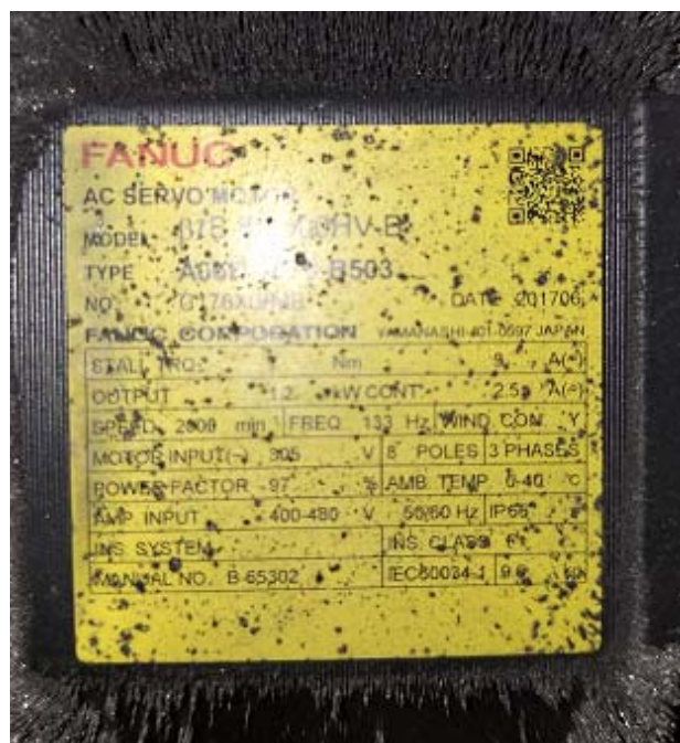
Slika 14. AC Model servo-motora "FANUC", Ferro-Preis d.o.o.
