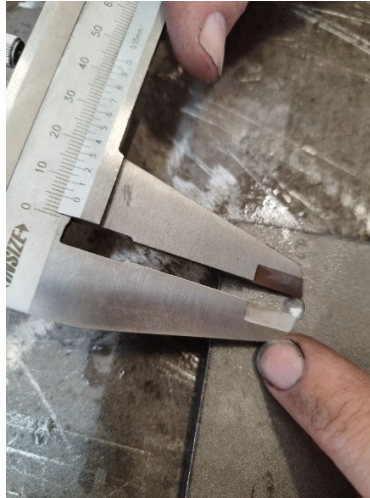
Slika 18. Analogni prikaz promjera oštećenja lima
