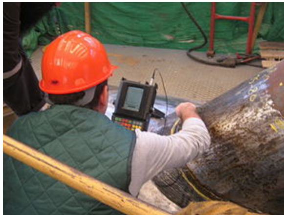
Slika 2. Ispitivanje zavora ultrazvukom
