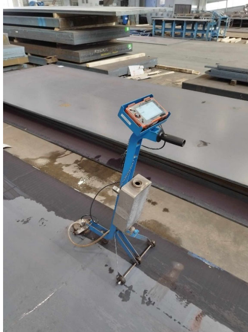
Slika 13. Prikaz uređaja i način ispitivanja lima
