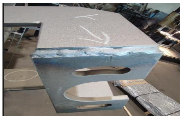
Slika 36. Nepravilan oblik zavara
