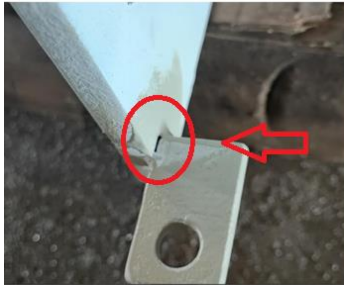
Slika 47. Nedostatak zavora na kotlu
