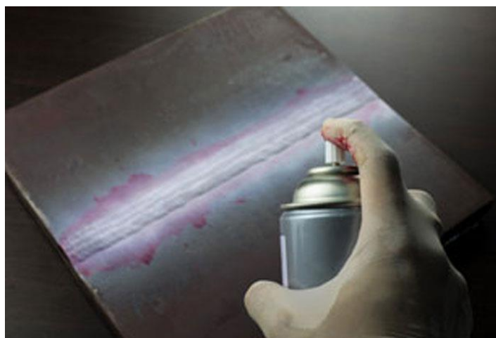
Slika 15. Primjena razvijaača na penetrant
