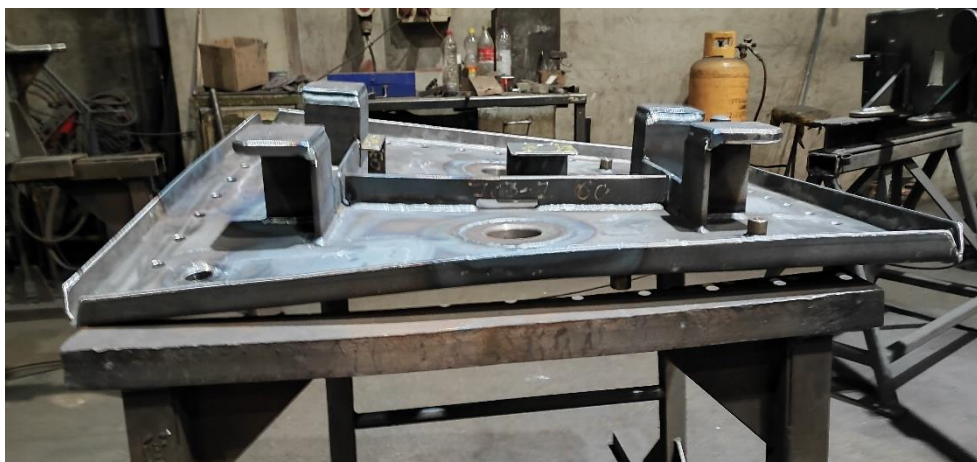
Slika 18. Deformacija materijala tijekom procesne kontrole
