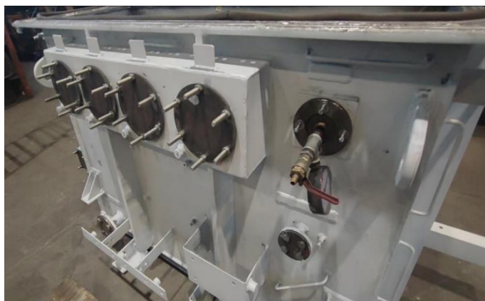
Slika 29. Držanje određenog tlaka u kotlu
