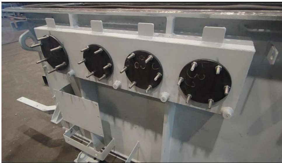
Slika 51. Zatvaranje rupa na kotlu
