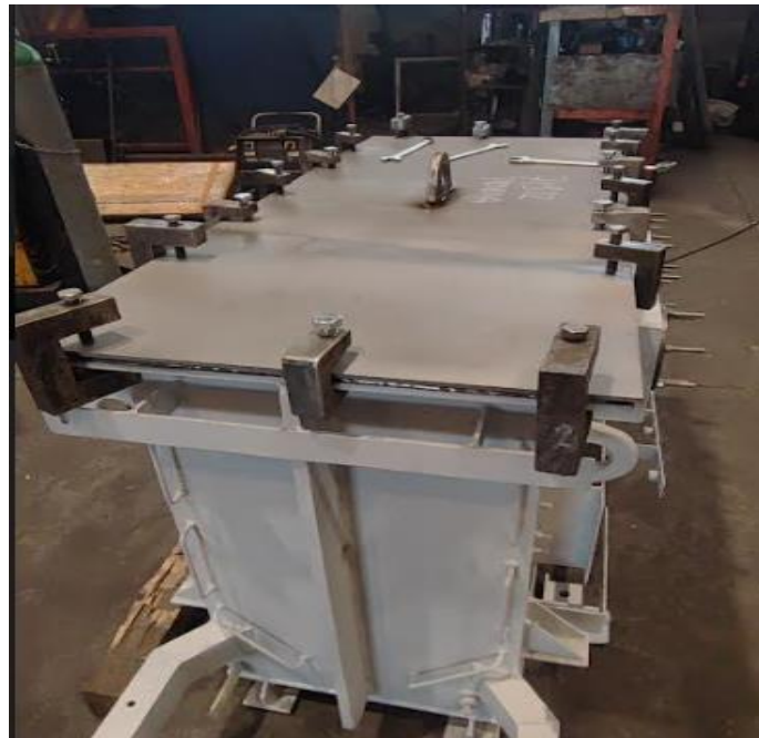
Slika 52. Zatvaranje okvira kotla
