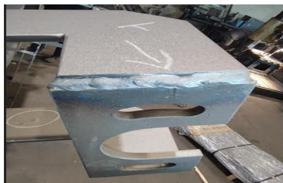
Slika 36. Nepravilan oblik zavara
